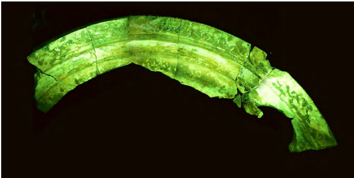
Fot. 12 Marmurowa mensa- badania w promieniowaniu UV – rejestracja w luminescencji wzbudzonej UV
