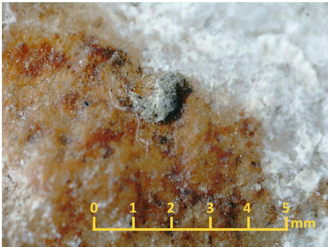
Fot. 30 x25 Zdjęcie mikroskopowe zaplamienie na odwrociu mensy, rejestracja w pow. x 20
