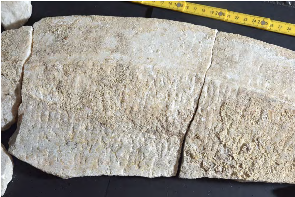
Fot. 16 nawarstwienia węglanowe i pochodzące z zaprawy wapiennej na odwrociu mensy
