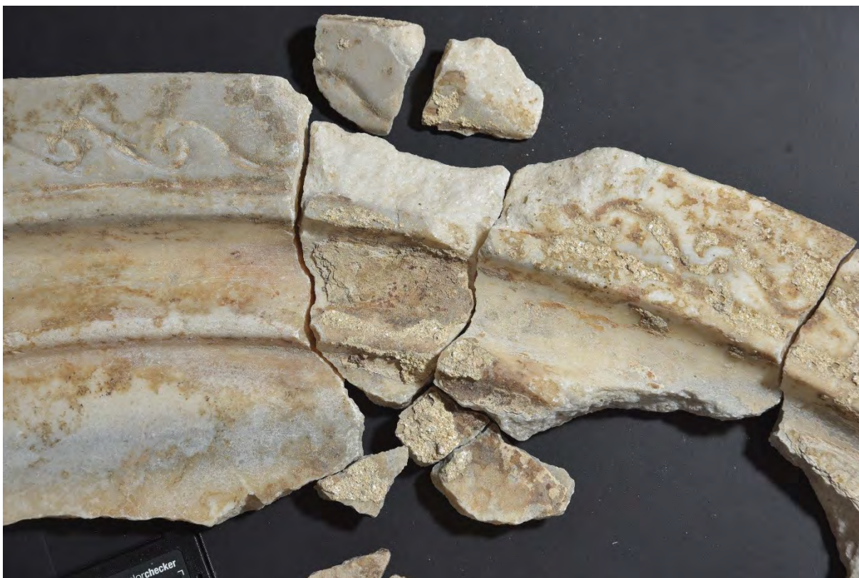
Fot. 15 Nawarstwienia z zapraw wapiennych na powierzchni profilowań
