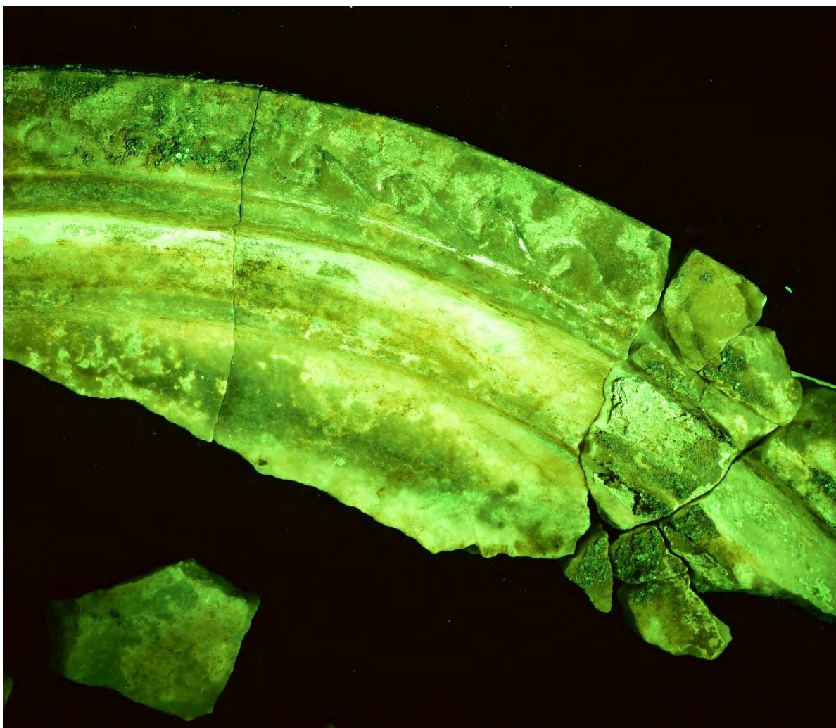
Fot. 13 Marmurowa mensa- badania w promieniowaniu UV – rejestracja w luminescencji wzbudzonej UV
