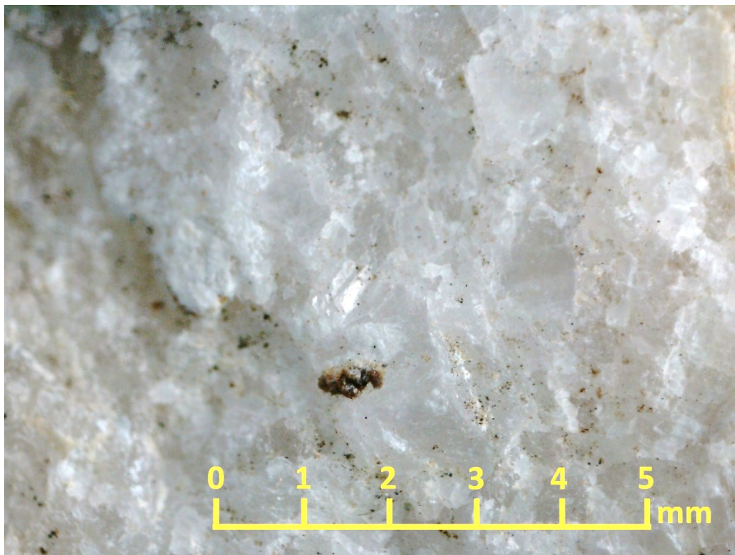
Fot. 28 Zdjęcie mikroskopowe przełamu, marmur rejestracja w pow. x 20
