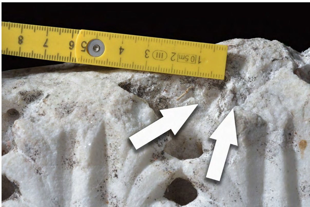
Fot. 38 Fryz akantowy – 2 ślady użycia wiertła w tle płaskorzeźby o średnicy 5 mm
