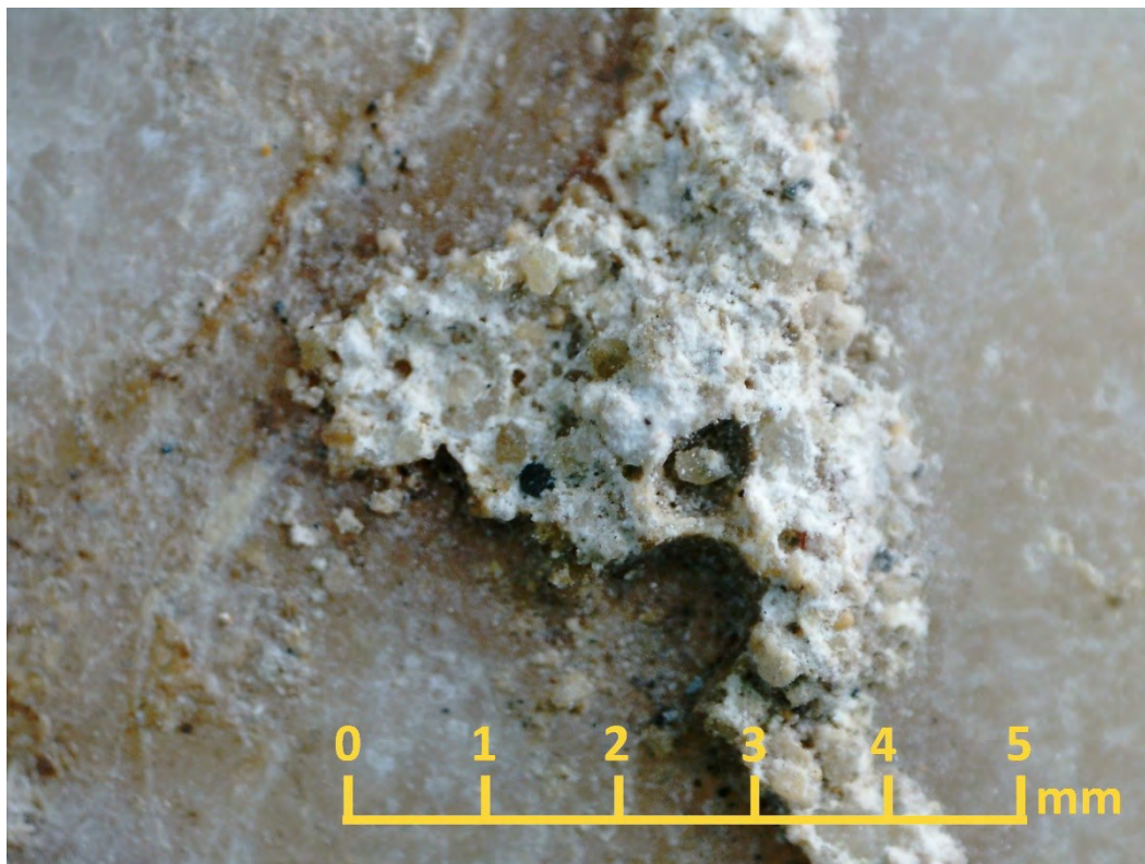
Fot. 32 Zdjęcie mikroskopowe, nawarstwienia - zaprawa wapienno piaskowa, rejestracja w pow. x20
