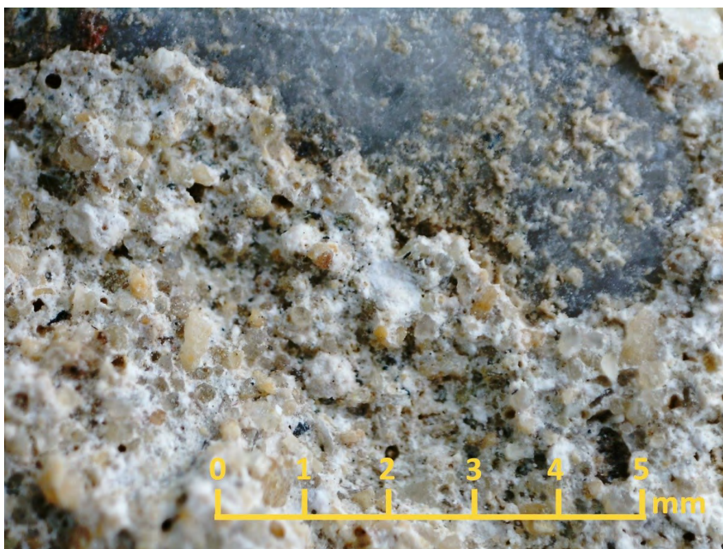
Fot. 33 Zdjęcie mikroskopowe, nawarstwienia - zaprawa wapienno piaskowa, rejestracja w pow. x 20
