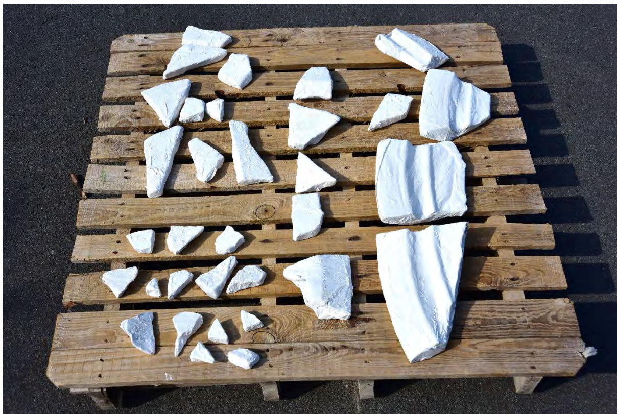
Fot. 20 Fragmenty podczas procesu odsalania
