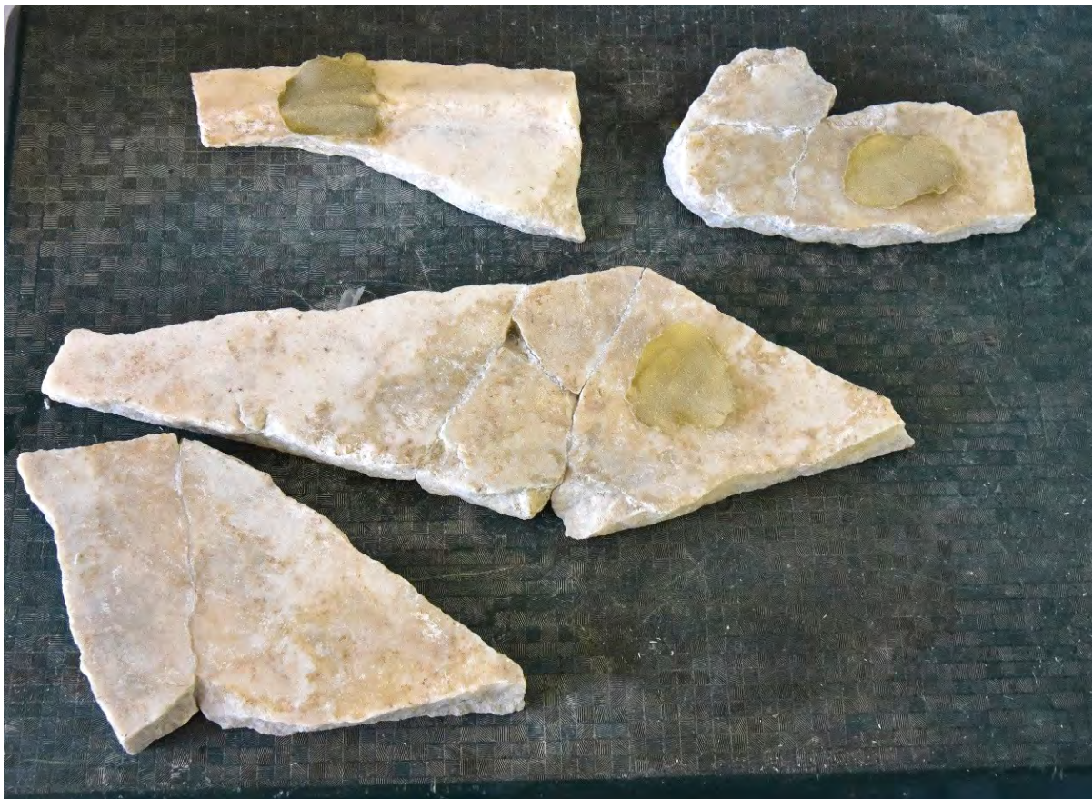
Fot. 22 Testy czyszczenia preparatem Clean Galena na fragmentach mensy
