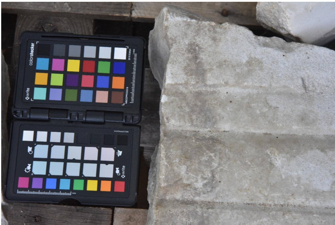
Fot. 11 Nawarstwienia węglanowe zacierające indywidualne cechy materiału i formę rzeźbiarską
