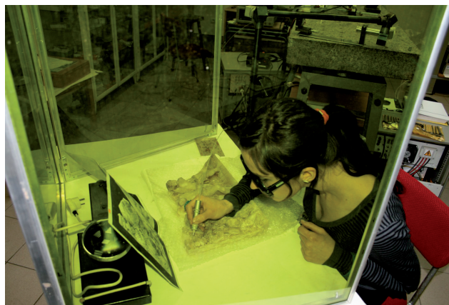
Rys.3.9.7. Osoby przypatrujące się procesowi laserowego oczyszczania obiektu są bezpieczne obserwując proces zza parawanu o odpowiedniej wartości gęstości optycznej dla promieniowania o długości fali 1064 nm. Operator nosi okulary. Fot. J. Marczak.
