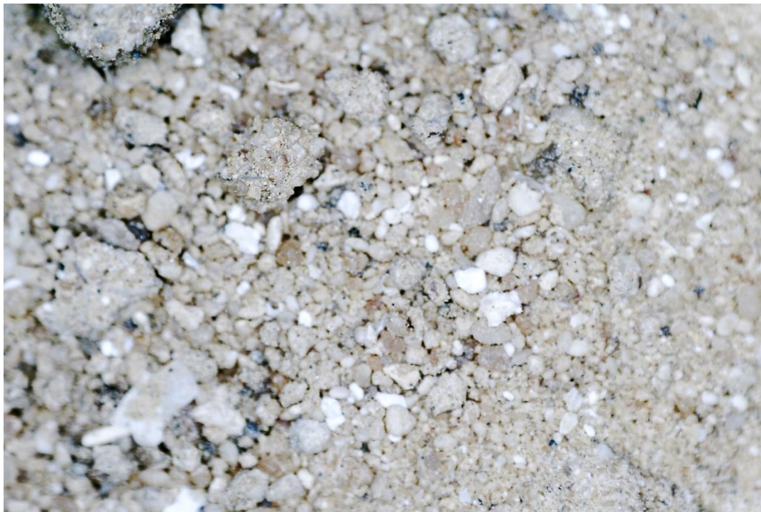
Fot. 42 Wypełnienie murów piaskiem. Dom H1. Powiększenie x 20
