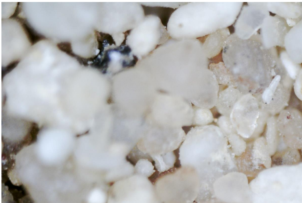
Fot. 41 Podłoże gruntowe z okolic domu H1. Powiększenie x 200
