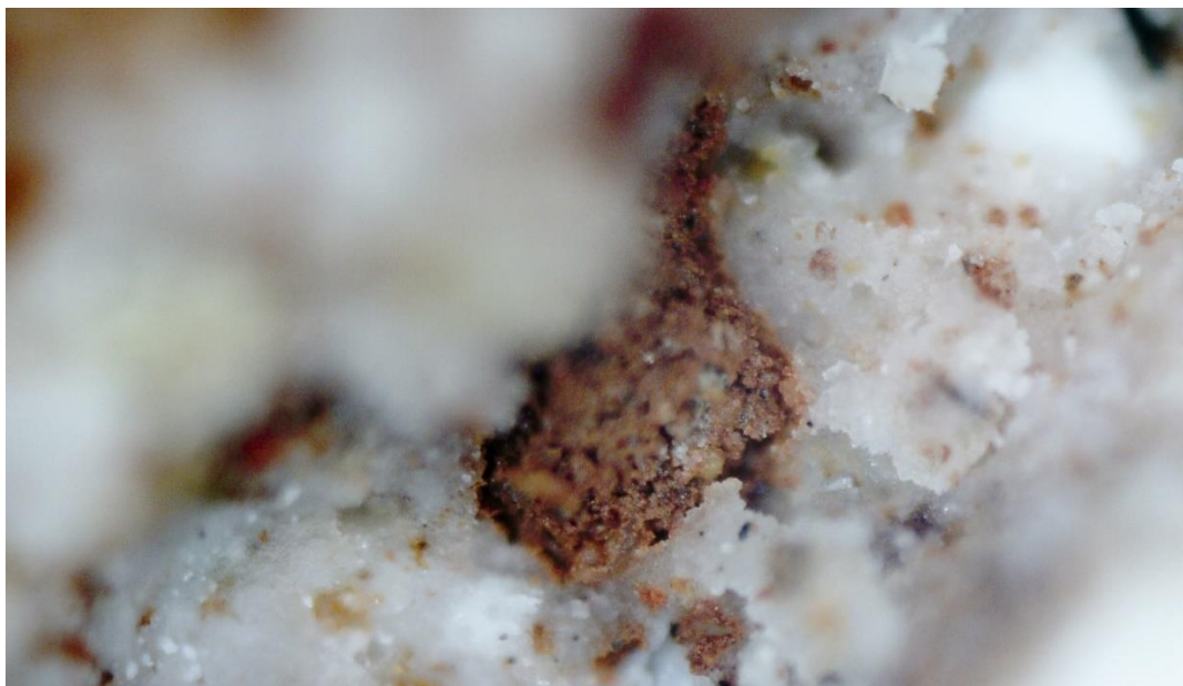
Fot. 34 Tynk z cysterny nr 1. Stratygrafia powiększenie x 200
