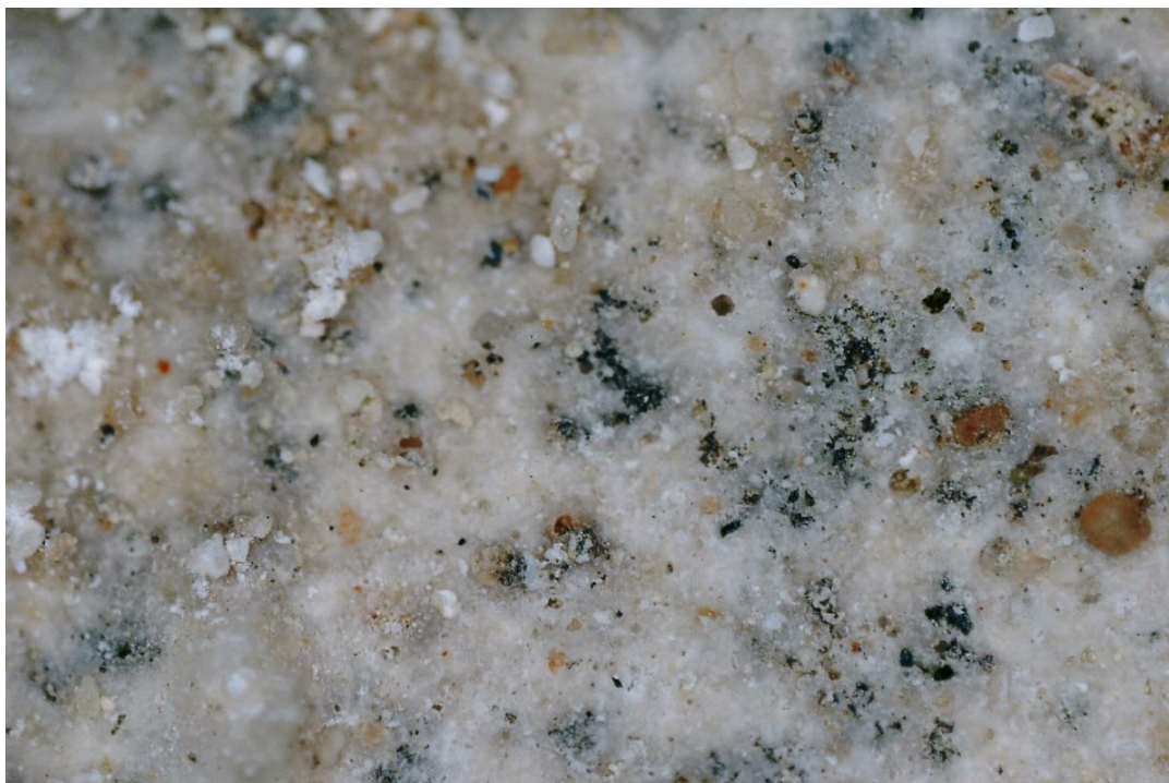
Fot. 21 Fragment zaprawy ze stopni klatki schodowej domu H1. Obraz w powiększeniu x 20. P2 powierzchnia zewnętrzna zaprawy
