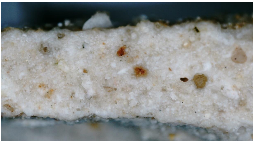
Fot. 22 Fragment zaprawy ze stopni klatki schodowej domu H1. Obraz w powiększeniu x 20. P2 stratygrafia
