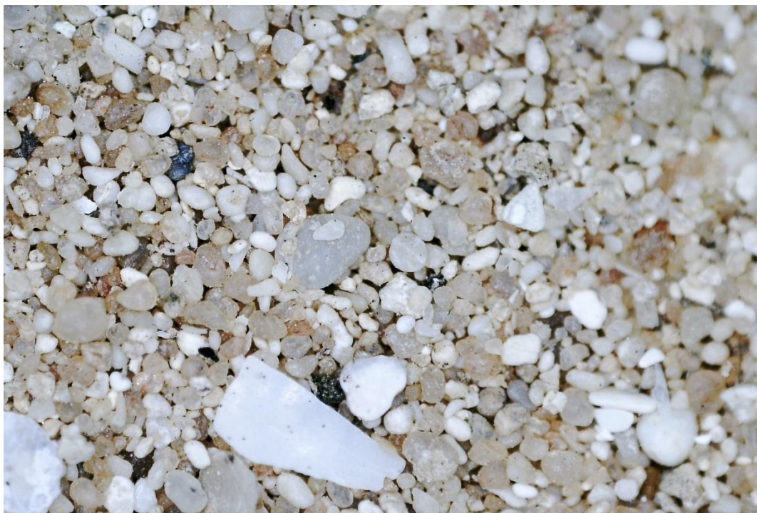
Fot. 40 Podłoże gruntowe z okolic domu H1. Powiększenie x 20
