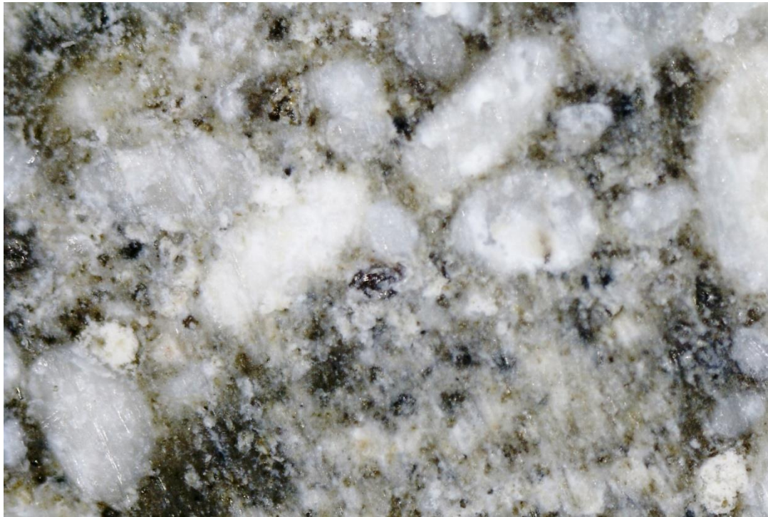
Fot. 37 Tynk ze studni cysterny nr 2. Powiększenie x 200
