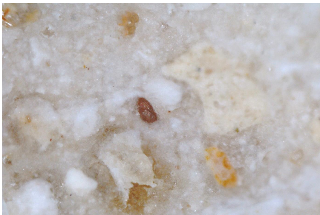
Fot. 27 Fragment zaprawy ze spoiny bloków za ściany zachodniej klatki schodowej, dom H1. P4 powiększenie x 200
