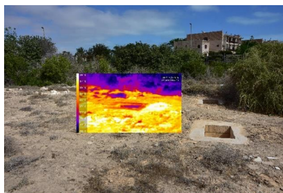
Fot.3,4 Rejestracja termowizyjna terenu uwidoczniała anomalie termiczne podłoża. Dzięki czemu można rozpoznać podziemne konstrukcje murowe
