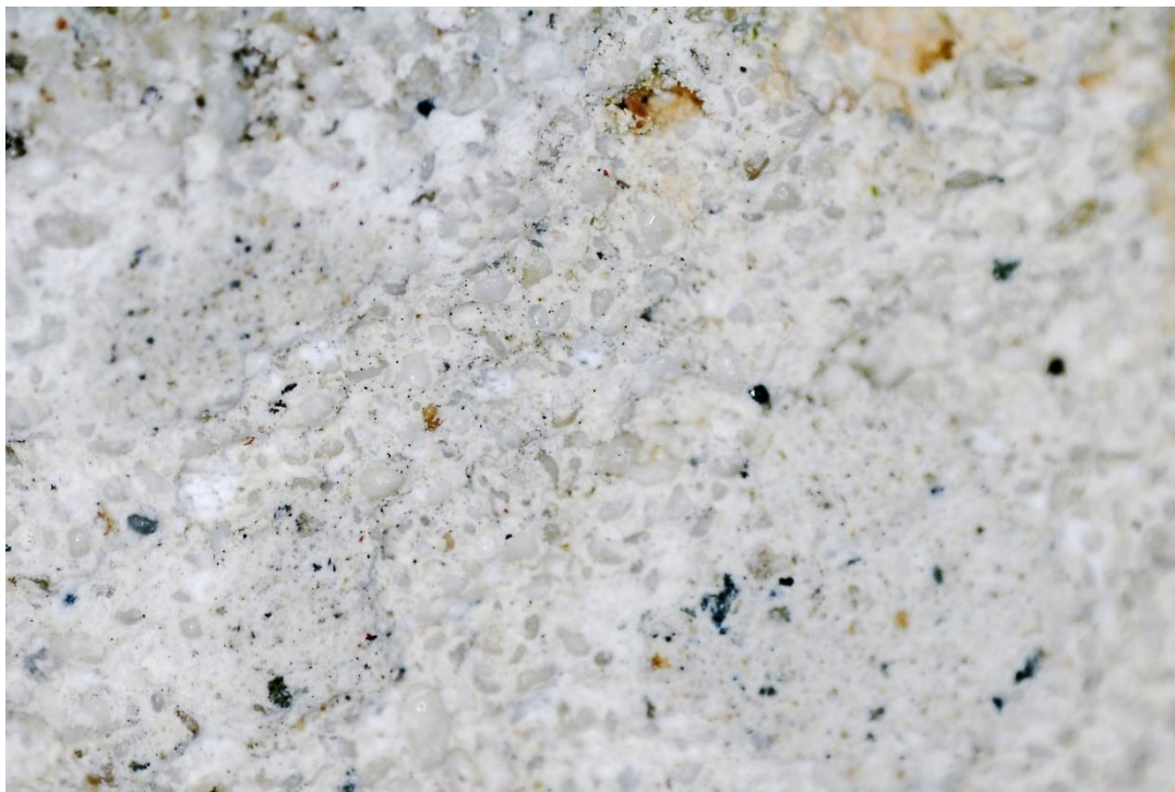
Fot. 30 Zaprawa mocująca płytowanie posadzki w domu H. Powiększenie x 20
