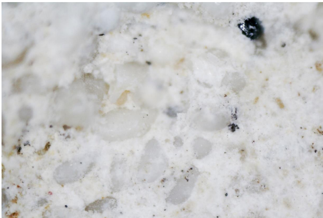
Fot. 31 Zaprawa mocująca płytowanie posadzki w domu H. Powiększenie x 200
