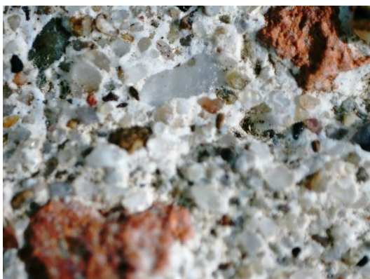
Fot. 9. Zaprawa z korony muru kamiennego, zdjęcie mikroskopowe, pow. x 20
