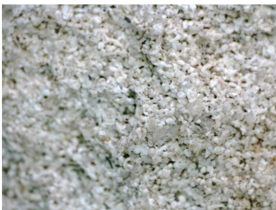
Fot. 27. Zdjęcie mikroskopowe wapień pow. x 20
