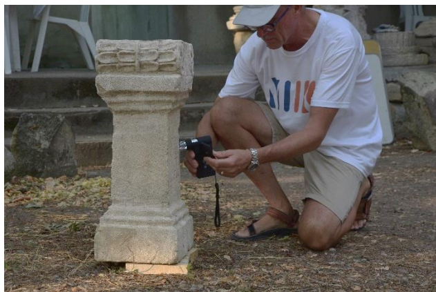
Fot. 16. Badania mikroskopowe struktury kamienia
