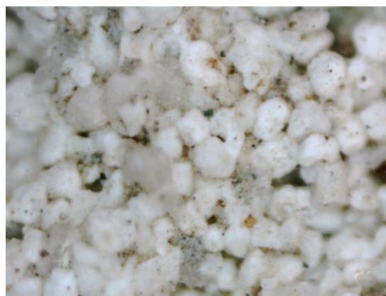
Fot. 28. Zdjęcie mikroskopowe wapień pow. x 500
